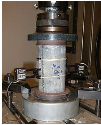
Ensayo de compresión en hormigón
