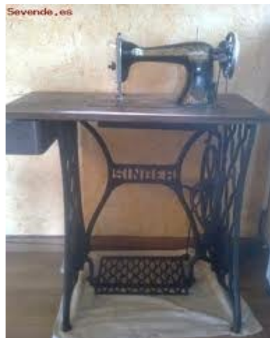
Ejemplo de mecanismo de biela balancín en una máquina de coser clásica
