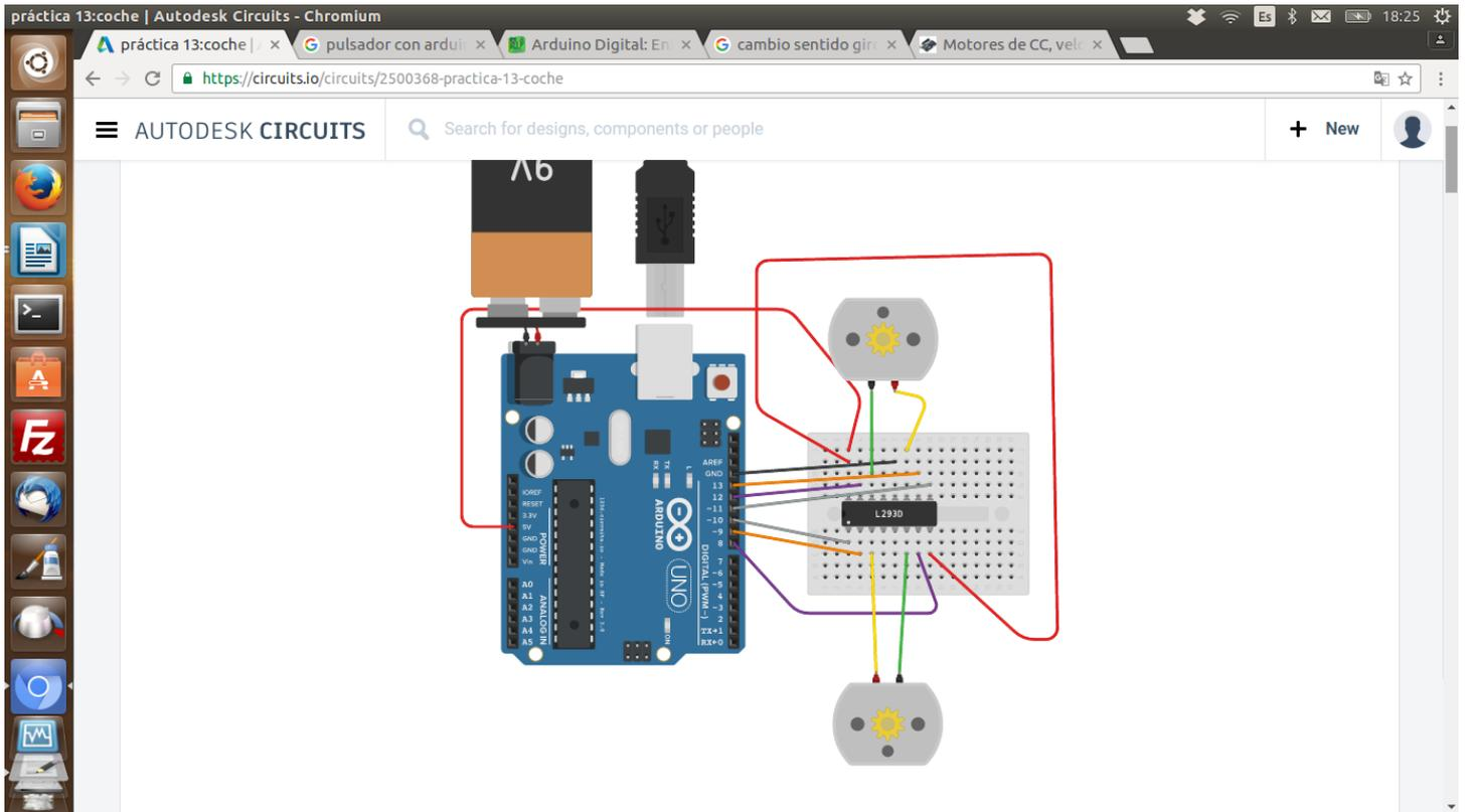
**ENCHUFAR LA FUENTE Y LUEGO SIN DESCONECTARLA CARGAR EL CÓDIGO CON EL USB (DA PROBLEMAS CON EL ARDUINO GENUINO DEL INSTITUTO Y EL L293D) CONECTAR LA CONEXIÓN VIN ANTIGUA DEL CHIP A 5V.**
